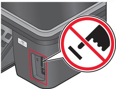
**警告—可能的损坏：**当正在打印、读取或写入存储设备时，请不要触摸任何电缆、任何网络适配器、任何接口、存储设备或图中所示的打印机区域，否则可能会发生数据丢失。
