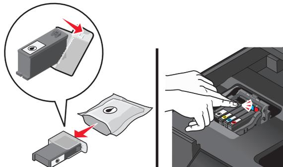
**注意：**取下保护帽后请立刻安装新的打印墨盒，以避免墨水暴露在空气中。
