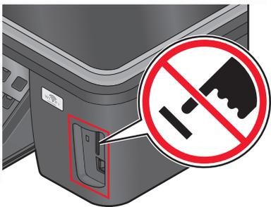
**警告—可能的损坏：**当正在从 PictBridge 兼容数码相机中打印时，请不要触摸 USB 电缆、任何网络适配器、任何接口或图中所示的打印机区域，否则可能会发生数据丢失。
