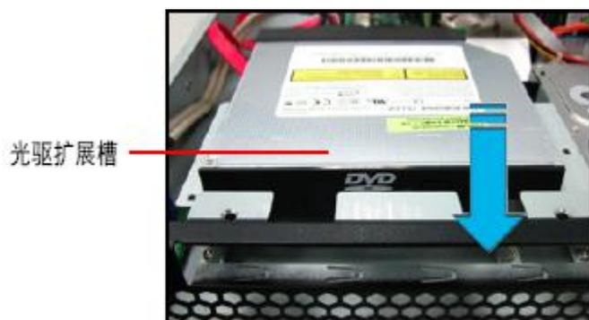
3、使用十字螺丝刀拧紧光驱，固定在机箱内；
