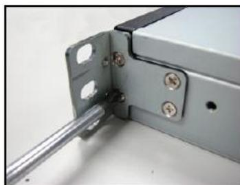
确保内层导轨段的扁平端朝向机箱的正面，而黄铜色突卡面朝外。使机箱中的孔与导轨中的孔对准，用导轨套件中的最小的螺丝拧紧导轨。
