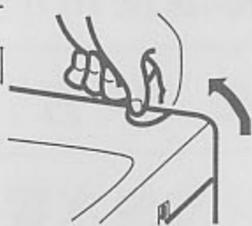
2. 将干燥机的排水软管插入排水口。
