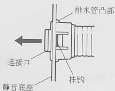
6. 将排水管从左侧孔的外边插入, 使连接口的凸部与静音底座的凹部相吻合, 并使连接口的挂钩确实嵌入静音底座。
