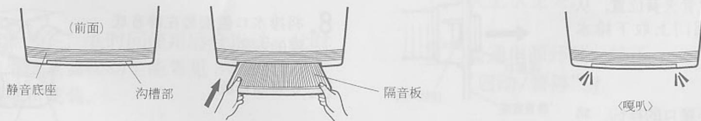
3. 将机身向后倾斜,用所附螺钉将隔音板与底托固定。
