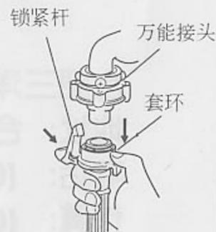
4. 在水龙头一侧, 按住锁紧杆, 将套环降低, 取下软管。在本机侧松开端部螺母取下。
