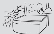
不要用水喷淋、冲洗冰箱，也不要将冰箱放置在潮湿、易溅上水的地方，以免影响冰箱的电气绝缘性能。
