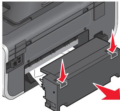
**⚠️ 当心—可能的伤害：**双面打印部件后面的区域带有突出的棱角（纸张通道的一部分）。为了避免受伤，当您为了清除卡纸而接触此区域时，请特别小心。
