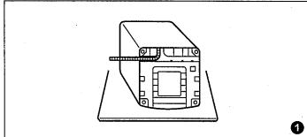
② 將排水管從右側拉出後，將排水管小心壓入左側。
