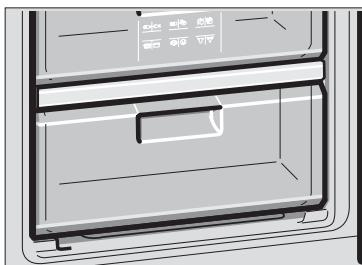
变温冷冻室内的温度在 -4~-18°C 之间可调，在此环境下，对食品进行浅冷冻，食品的保存时间约在二到三周。食品保鲜时间更长久，又不致使食品冻得太硬，烹饪前无需解冻，方便实用。
