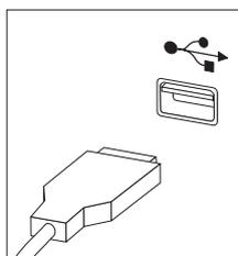
**1.4.2 将鼠标连线连接到相应的鼠标接口。**（部分机型不配置鼠标，请用户根据需要自行配置。）
