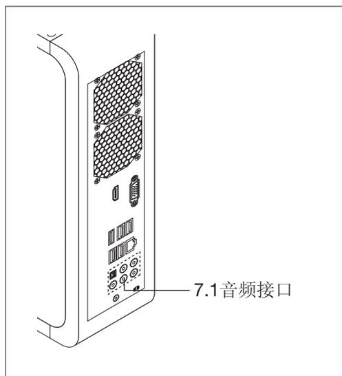
六个 I/O 口，分别是：音源输入，麦克风，音源输出，后喇叭输出，中央 / 重低音输出，侧面喇叭输出。
