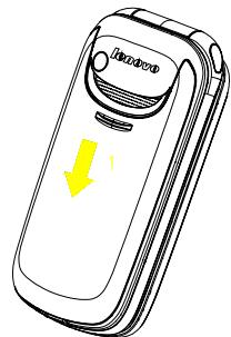
2. 用指尖伸入电池顶端弧形凹处将电池翻起取出（2）。
