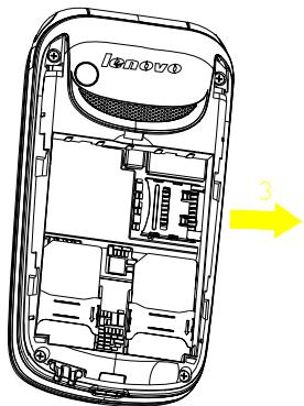
4. 将存储卡金属面朝下推入卡槽 (4)。
