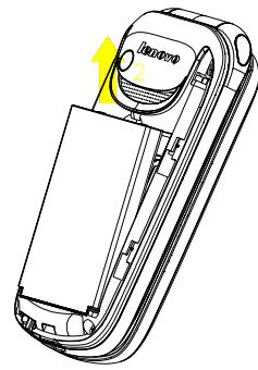
3. 插入 **SIM** 卡：确保 **SIM** 卡和手机的金属触点相互正对，且 **SIM** 卡的切角朝向手机的顶部（3）。
