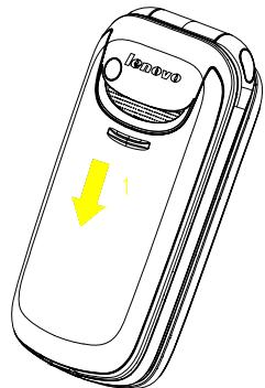
2. 取出电池：用指尖伸入电池顶端弧形凹处将电池翻起取出（2）。
