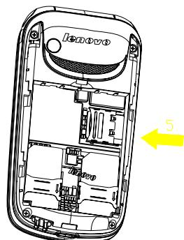
6. 确保电池和手机的金色触点相互正对并装入电池（6）。
