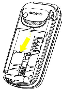
4. 装入电池：确保电池和手机的金色触点相互正对并装入电池（4）。
