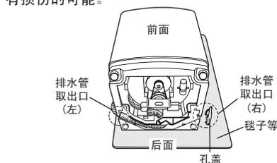
2. 将排水管从左侧的固定卡口处取出，按照“排水管取出口(左)①”、“卡口②”、“卡口③”顺序取出排水管。注意：取出时，应避免排水管损伤、破损。
