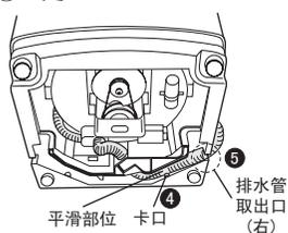
4. 将孔盖对准“排水管取出口(左)”处孔盖，然后轻轻扶起并放好洗衣机。
