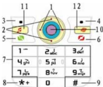
**1.左右键：**编辑时左右移动光标；待机状态，按**左键**进入**[情景模式]**菜单，按**右键**进入**[短信息]**菜单；在照相机、视频录像机预览状态，按**左右键**可调整**曝光补偿**参数；在某些二级菜单，按**右键**相当于开启选定菜单，按**左键**相当于返回上一级菜单。
