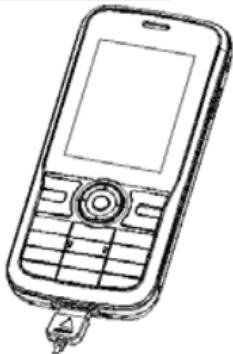
将充电器的接口插入手机的充电器插座。
