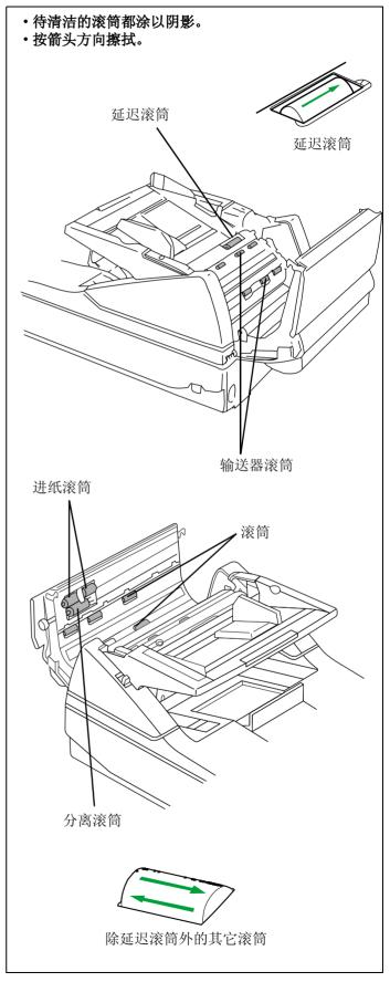
**4** 朝自己拉出纸挡板并用手朝自己拉前门 开启拉手。然后完全打开前门。
