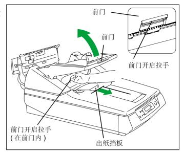
5 用辅助滚筒清洁纸 (KV-SS03) 清洁扫描区镜片、CIS 镜片、传感器板和传感器滚筒。
