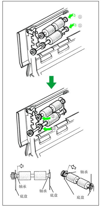
**8** 将进纸输送器稍稍往下倾斜一个角度并如右图所示安装它。
