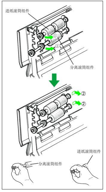
f 打开选购的"滚筒更换零件套"(KV-SS044),取出新的进纸滚筒组件和分离滚筒组件。如需消耗件和附件:请打电话给您的经
