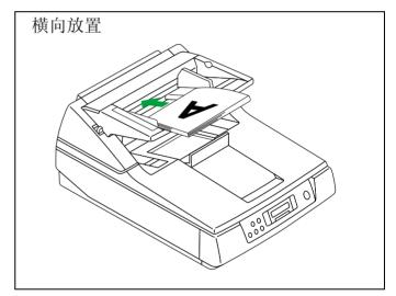
**5** 调整进纸导板至有待扫描的文件尺寸。 如有需要,将出纸导板调整至有待输出 的文件尺寸。
