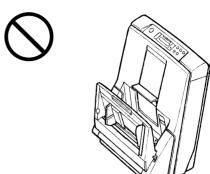
切勿置本机于靠近加热设备和空调排气口处。切勿置本机于湿度极高或极低的室内。
