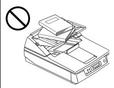
切勿将本机放置在有大量烟雾、灰尘、化学烟雾或振动的场所。
