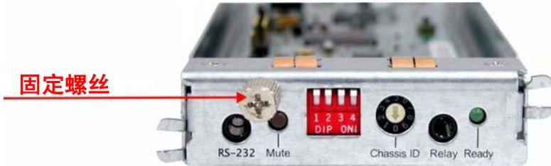
c. 使用螺丝刀拧紧固定螺丝，使其固定在机器主体。
