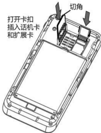
**注意：**请勿带电插拔话机卡和扩展卡！请注意保管话机卡，不要弯曲或划伤，也不要接触静电或浸水。
