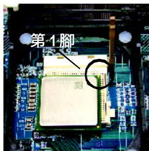
4. 將處理器的第一腳(金色三腳記號處)對準插座上的缺腳記號再將處理器插入插座。處理器插入定位後，再將連桿向下按至原位。◀
