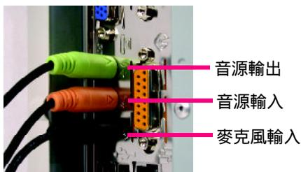
2. 當你安裝完音效驅動程式您可以在常駐程式列找到
