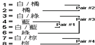
EIA/TIA 568A/B 規範 RJ-45 接頭製作標準說明圖
