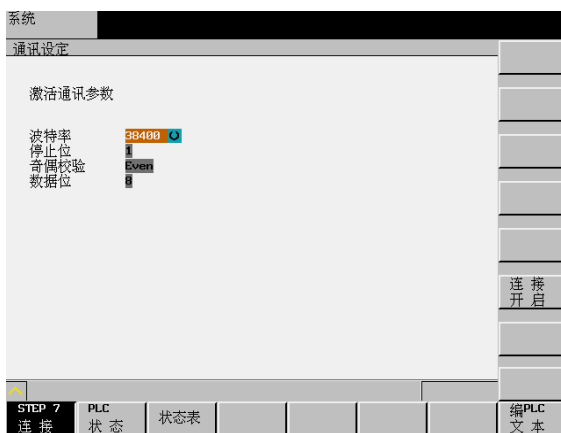
图7-12 激活/关闭用于编程工具的RS232接口
