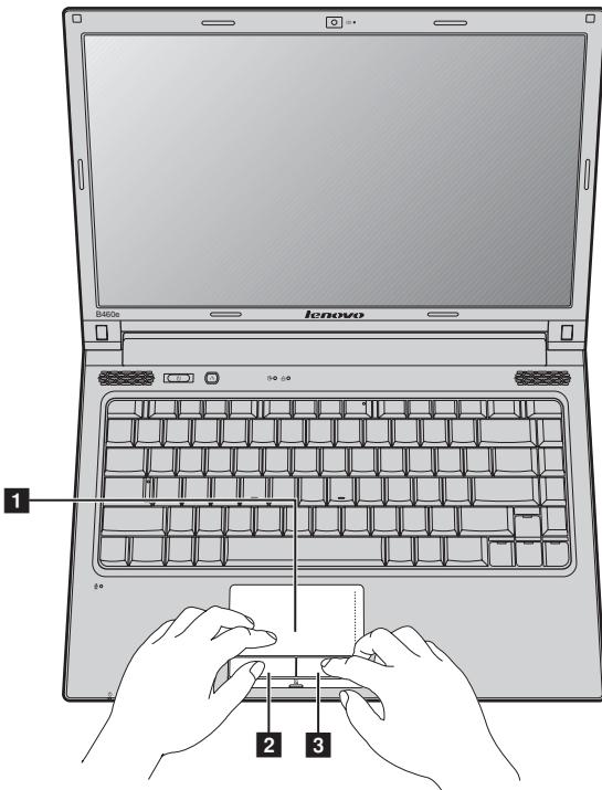
**1 触控板** 屏幕上的光标会与手指在触控板上划过的相同方向运动。
