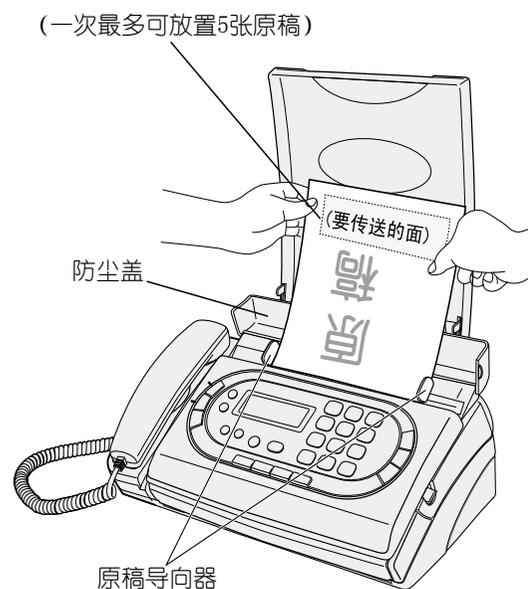
1 请先打开防尘盖, 然后将原稿导向器的宽度调整到原稿的宽度。
