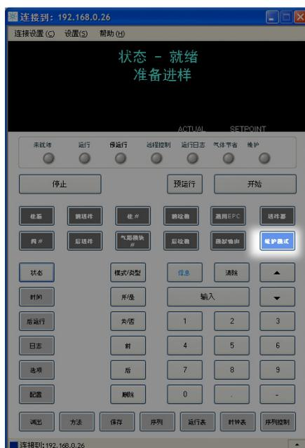
**[Service Mode]** (服务模式) 通过此键可以使用 GC 的维护功能和设置、服务计数器以及诊断功能。有关详细信息，请参见《高级用户指南》。
