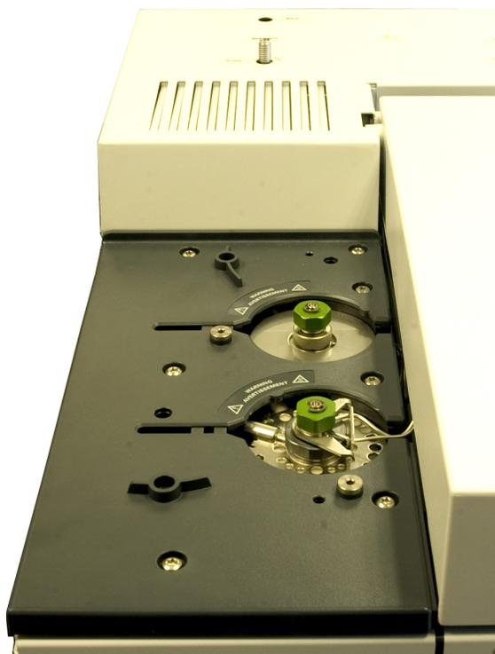
可以使用进样针手动将样品进样到进样口，或使用自动化进样设备（例如 Agilent 自动进样器或 Agilent 顶空进样器）。
