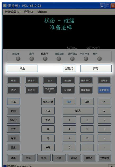
**[Prep Run]** (准备运行) 激活所需进程，使 GC 进入相应方法（如关闭不分流进样的进样口吹扫流量或从载气节省模式恢复正常流量）所述的启动状态。有关详细信息，请参见《高级用户指南》。
