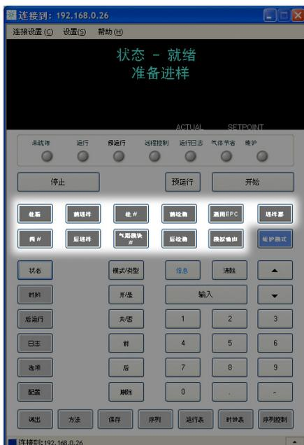
**[Oven]**（柱箱） 设置柱箱温度，包括恒温 and 程序升温。
