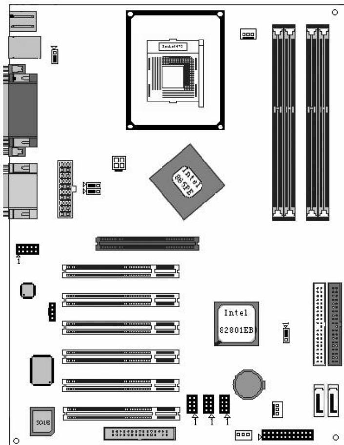
◇此主板有一个标准的电源接口和一个单独的 12V 电源接口，只可使用标准的 P4 电源。
