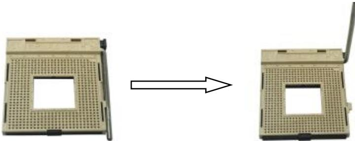
**b.**确认 CPU 插座和 CPU 的第一脚，将 CPU 放入 CPU 插座上将锁定杆从未锁定状态拨到锁定状态
