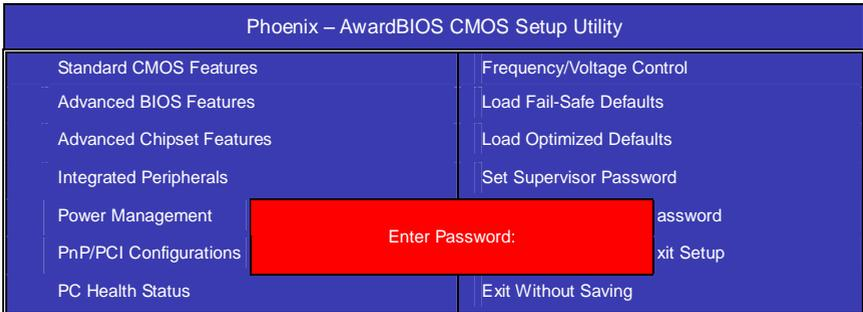
设定密码时，请于主画面下选择好项目，并按下 **Enter**，画面中间即出现的方框让您输入密码：**ENTER PASSWORD**。最多可以输入 **8** 个数字，输入完毕后按下 **Enter**，BIOS 会要求再输入一次，以确定刚刚没有输入错误，若两次密码吻合，便将之记录下来。
