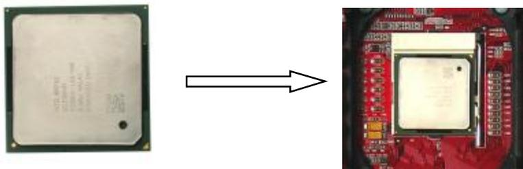
**c.**将 CPU 风扇盖上，电源线接到 CPUFAN 插座上，上好保险夹
