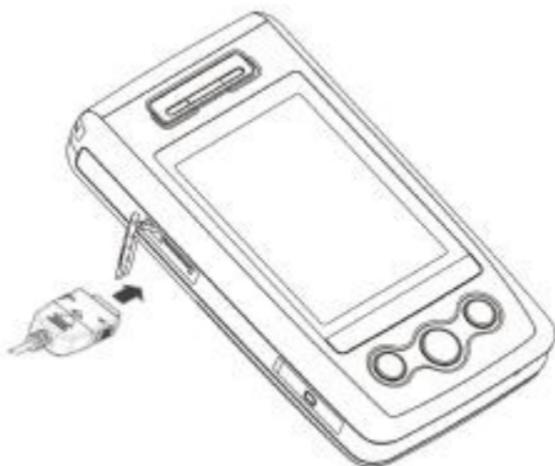
充電時話機螢幕電池容量圖示自右向左動畫顯示，電池充滿以後電池容量以滿格靜止顯示。
