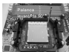
PASO 1: Levante la Palanca del Zócalo
