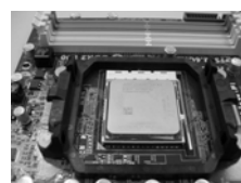
FASE 4: Abbassare e bloccare la levetta socket
