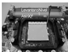
PASSO 1: Levantar o Nível de Tomada Até 90°
