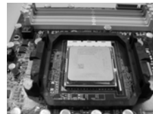
步骤 4: 下推并锁住插座拉杆
