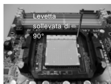
FASE 1: Sollevare la levetta socket
