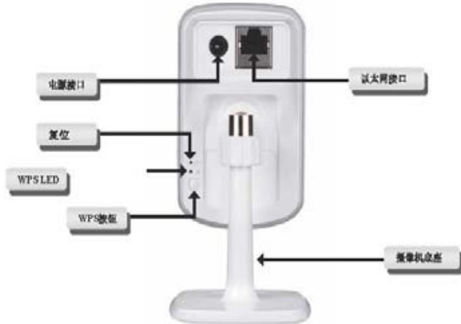
1. 首先将附带的以太网线插入 DCS-930L 后面板上的网线接口，另外一端接入您的局域网内，使其接入网络中。
