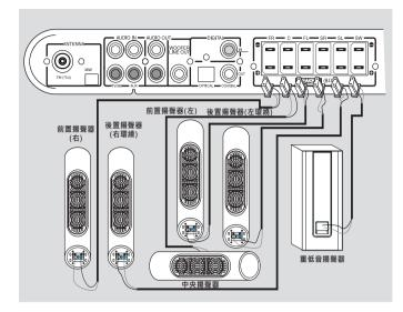
根據插孔和揚聲器插頭的相應顏色,使用隨附的揚聲器電纜 連接隨附的揚聲器系統。把揚聲器導線的插頭完全插入到 DVD系統的插孔中。
