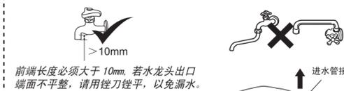
前端长度必须大于10mm, 若水龙头出口端面不平整, 请用锉刀锉平, 以免漏水。
