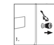
拆除包装螺栓, 并取出支撑块。
