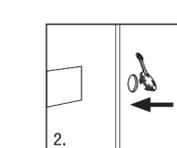
用防塑剂堵料, 将螺栓孔堵上。
