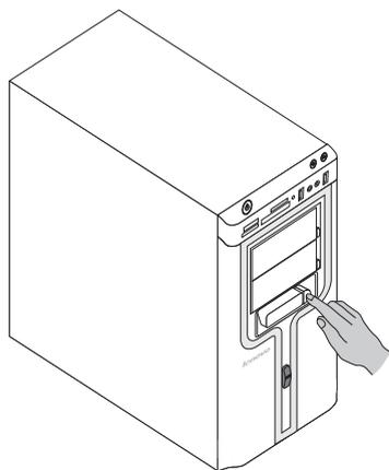
1. 按下热插拔硬盘旁边的按键,热插拔硬盘弹出。
