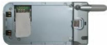
将 SIM 卡插在两个接线片下面，确保金属平面区域朝下，边角位置如上图所示；
