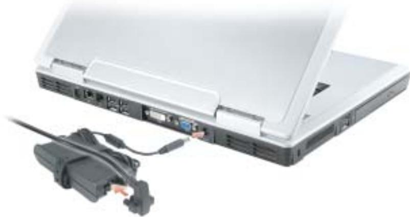
交流适配器将交流电源转换为计算机所需的直流电源。无论计算机电源处于打开或关闭状态，您均可以连接交流适配器。
