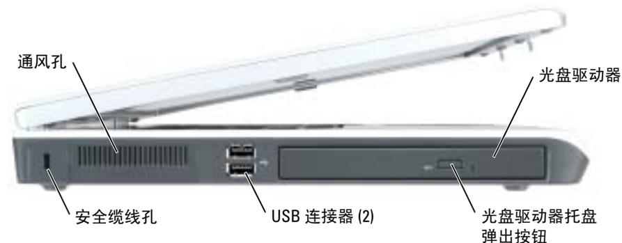
**光盘驱动器** — 您可以在光盘驱动器托架中安装 DVD 驱动器或其它光盘驱动器等设备。有关详情，请参阅第 94 页的“光盘驱动器”。
