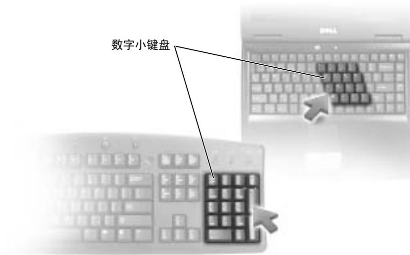
数字小键盘的功能类似于外部键盘上的数字小键盘。小键盘上的每个按键均具有多种功能。小键盘的数字和符号标为蓝色，位于小键盘按键的右侧。要键入数字或符号，请在启用小键盘后按 <Fn> 键和所需按键。
