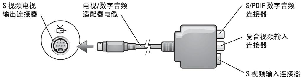
您的电视带有 S 视频输入连接器或复合视频输入连接器。根据电视配备的连接器类型，可以使用从市面上购买的 S 视频电缆或复合视频电缆将计算机连接至电视。如果音频设备不支持 S/PDIF 数字音频，您可以使用计算机侧面的音频连接器将计算机连接至音频设备。
