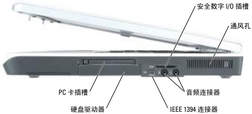
**安全数字 I/O 插槽** — 安全数字 I/O 插槽支持一个安全数字存储卡或其它 SDI/O 设备。使用安全数字存储卡可以保存或备份数据。
