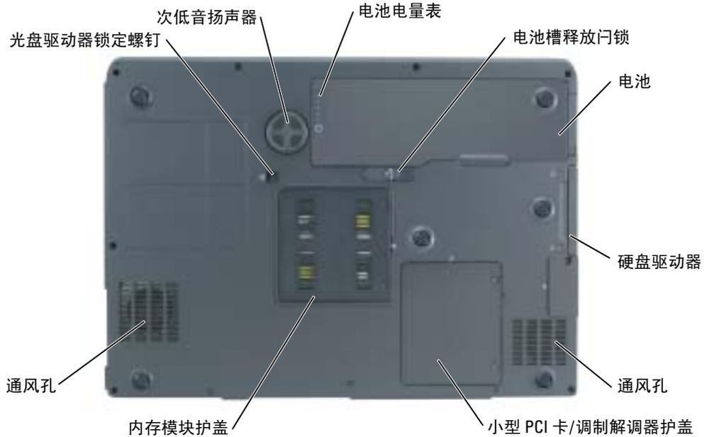
**电池电量表** — 提供有关电池电量的信息。有关详情，请参阅第 28 页的“检查电池电量”。
