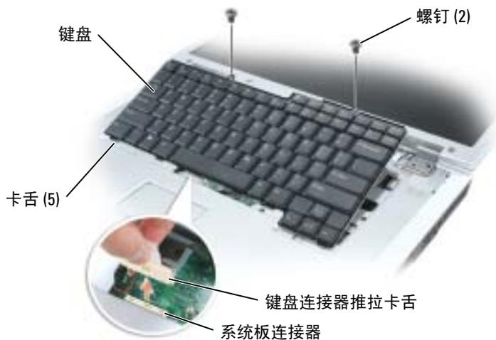
**注意：**为避免更换键盘时刮伤掌垫，请将五个卡舌沿着键盘前边缘钩到掌垫上，然后将键盘固定到位。
