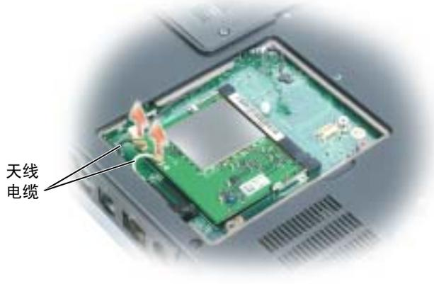
b 松开小型 PCI 卡，方法是掰开金属固定卡舌直至 PCI 卡轻轻弹起。
