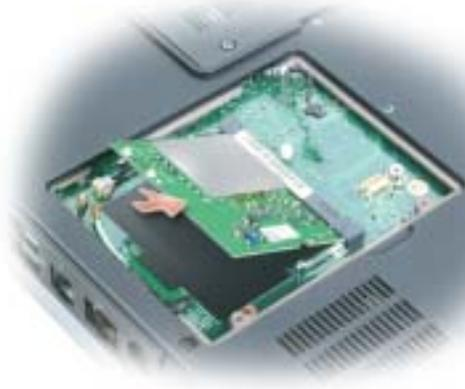
**⚠ 注意：** 为避免损坏小型 PCI 卡，切勿将电缆放在小型 PCI 卡的下面。
