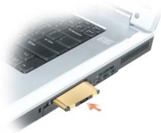
计算机能够识别大多数 PC 卡，并能自动载入相应的设备驱动程序。如果配置程序提示您载入制造商提供的驱动程序，请使用 PC 卡附带的软盘或 CD。
