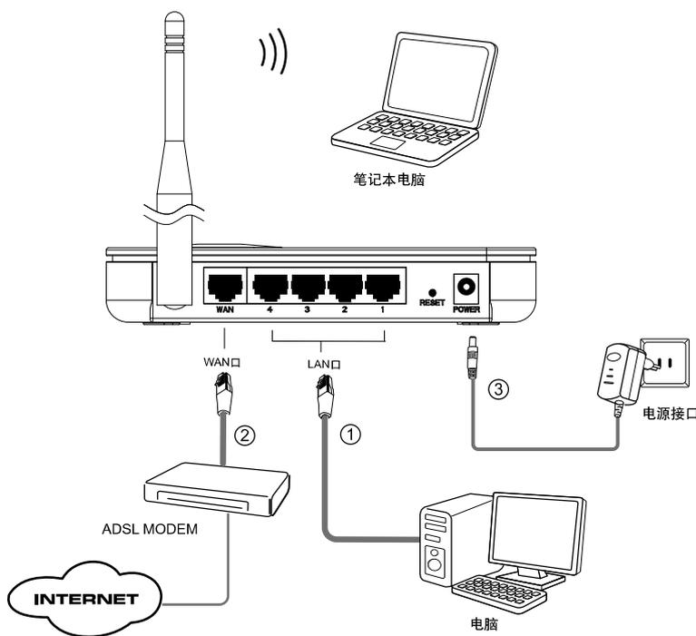
图 4-1 TL-WR740N 硬件安装示意图
