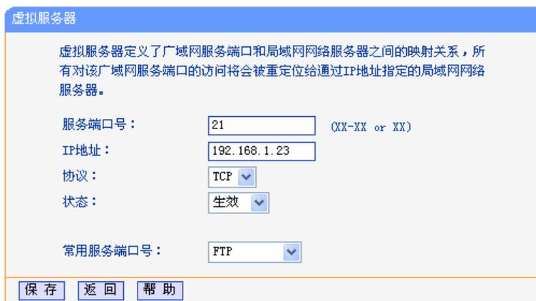
图 5-24 设置虚拟服务器条目
