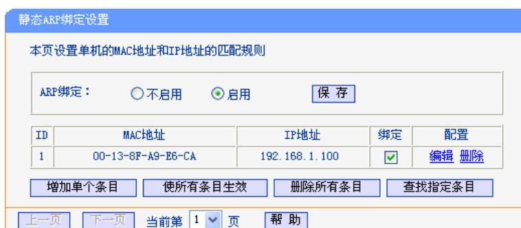
图 5-42 静态 ARP 绑定设置
