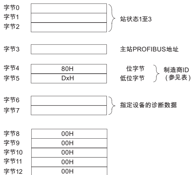
图 7-2 ET 200eco 从站诊断数据的结构
