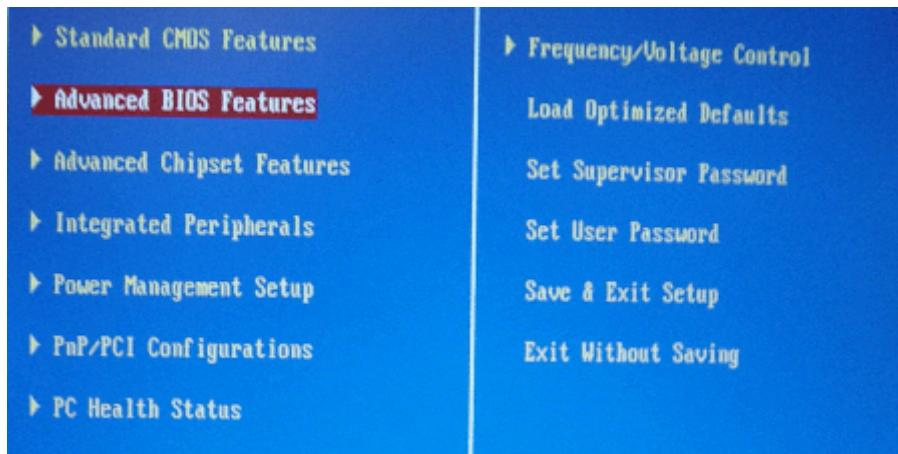
在这个界面下，您可以利用上下左右四个方向键来移动所选择的项目，利用回车键进入下面一级的子菜单，然后可以利用“Page Up”和“Page Down”键对各个参数进行修改。
