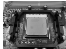
步骤 4： 下推并锁住插座拉杆
