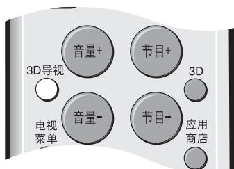
通过3D导视，您可以对本电视机的特色功能和第三方软件进行快速预览、操作，管理使用小工具，对相应内容进行订阅并查看电视以及家电设备运行的状态。
