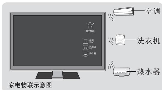
1 进入 [家电物联] 后，连接在网络上的海尔智能家电将自动显示其图标。
