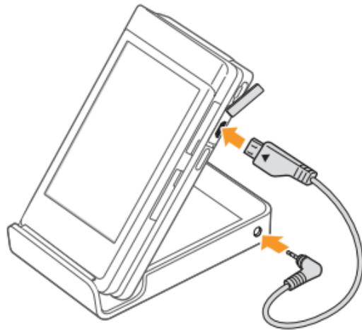
4 将旅行充电器的小端插头插入座式充电器背面的插口。
