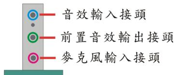
**音效输入接头 (蓝色)** 用来连接外接的 CD 光驱、卡式录音机与其它外接式音效装置，并藉此输出立体音效。驱动 Super 5.1 音效后，此连接端口则变为后置喇叭左右声道之输出。
