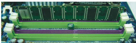
4. 内存模块以重复步骤 1、2 及 3 的方法，安装至 DIMM 插槽中。
