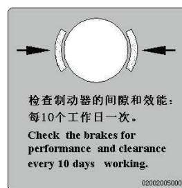
检查制动块的间隙
