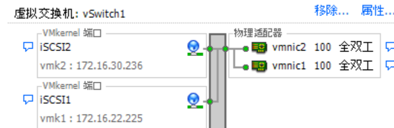
图 6-3 单个 vSwitch 上的 iSCSI 端口和网卡
