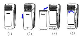
安装时按以下步骤进行: ①按下图(1)将电池金属触点端对应机身的弹片并且电池的防呆凸台 插入机身的方形槽,再按箭头方向将电池装到位;
