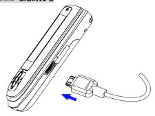
将充电器插上电源。 按图打开 I/O 盖帽,依箭头所示将电源接口插入。
