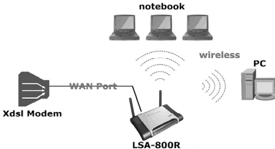
图 4 用无线连接路由器组成局域网
