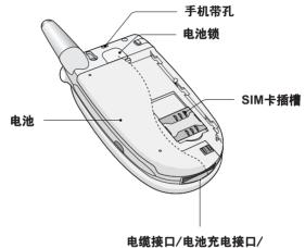
电缆接口/电池充电接口/ 免提车用组合接口
