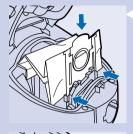
4 将新集尘袋的纸板片套入集尘袋固定架上的两个狭槽中。 尽量向下按。
