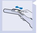
3 可用手柄上的滑动开关调节吸尘强度。
