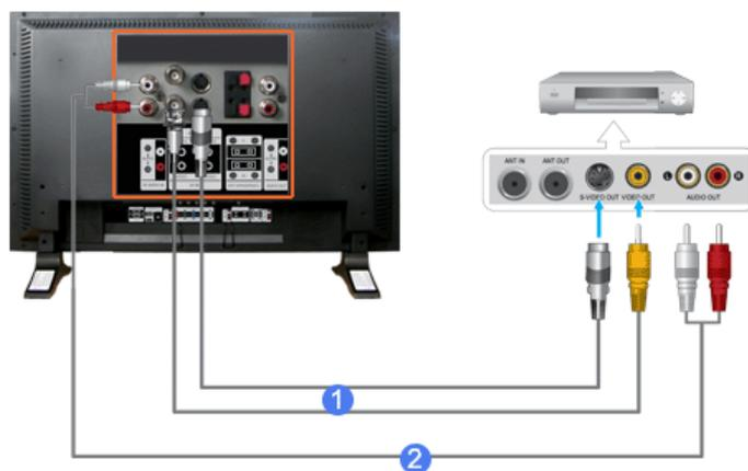
1) 诸如录像机或便携式摄像机之类的 AV Input 设备可通过 S-VHS 或 BNC 电缆连接到显示器的 **AV IN [VIDEO]** 或 **AV IN [S-VIDEO]** 。
