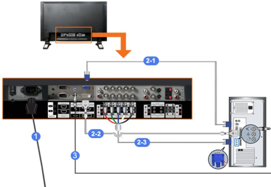
1) 将显示器的电源线连接到显示器背面的电源端口。
