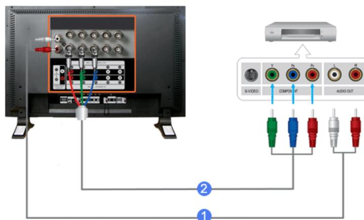
1) 用一套音频电缆连接显示器的 **COMPONENT AUDIO IN [L-AUDIO-R]** 和 DVD 播放器的音频输出插孔。
