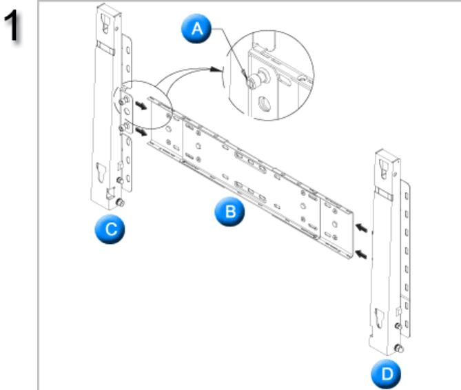
按箭头方向插入并旋紧外加螺丝。完成后，在墙上安装墙上托架。
