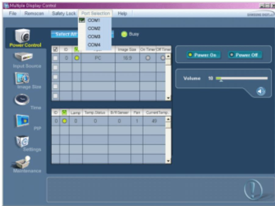
1. Multiple Display Control（多显示器控制）最初的设置值为 COM1。
