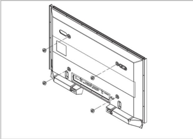
将步骤 2 中的 4 个螺丝（塑料铰链 + 螺丝 B）旋紧到产品后面的孔中。
