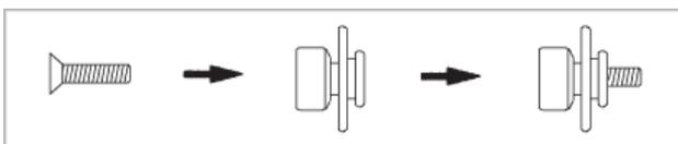
将螺丝 B 插入塑料铰链中。
