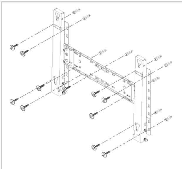
将每个锚固定在相应的孔中。参见安装图并在墙上标记钻入点。使用 5.0 毫米钻头钻孔，孔深超过 35 毫米。
