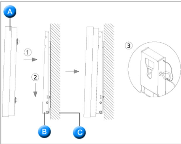
拆下安全别针 (3)，然后将 4 个产品支架插入到相应的托架孔 (1) 中。然后放置产品 (2)，以便产品可以牢固地固定在托架上。确保产品重新插入并旋紧安全别针 (3) 以安全地将产品放在托架上。
