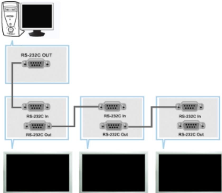
Multiple Display Control (MDC) (多显示器控制) 是一个允许多个显示器轻松地同时工作于一台计算机上的应用程序。用一个标准串行通信接口 RS-232C 在计算机和显示器之间进行通信。因此，在计算机的串行端口和显示器的串行端口之间应通过一条串行电缆连接。
