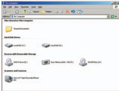
XDCAM 作为可移动存储设备显示 (i.LINK, 文件读取模式)
