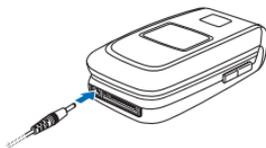
充电时间的长短取决于使用的充电器和电池。例如，在待机状态下使用 AC-3 充电器为 BL-4C 型电池充电约需 2 小时 12 分钟。
