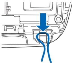
取下手机后盖和电池。如图所示，穿入腕带并将其拉紧。重新安装电池和后盖。
