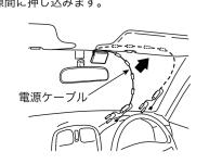
**4** A ピラーカバーを外し、電源ケーブルを通します。
