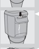
16 向下推热水控制杆,通过排水口和热水出水口将水全部倒出。▶ 加热器中的水现已全部倒出。
