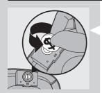
電池在正常使用狀況下能維持 2 年。 當顯示器 上閃爍電池符號時,請更換電池。
