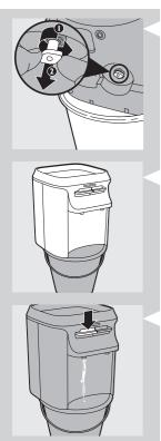
14 取出淨水箱,將給水裝置側放,再將底部的導流塞拉開。 請注意,當您取下導流塞時,可能會有熱水從開口流出。 注意:給水裝置頂端可能會滴水。
