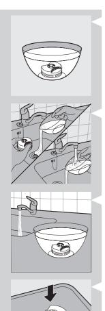
**6** 将水质软化器放进装有盐水溶液的碗里至少 1 小时。确保水质软化器完全浸在水里。
