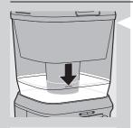
在饮水机内的加热器完全装满水之前,即除非见到净水水箱中有水, 否则请勿打开背面的通电按钮。
