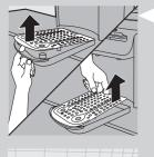
4 將手指穿過滴盤邊緣的孔,將滴盤蓋自固定釘推開。然後握住滴盤蓋的後端將其舉起,從滴盤上取下。
