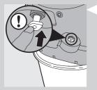
17 将排水塞塞回出水装置的底部。
