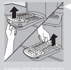
4 将手指放入水盘边缘的孔中,将水盘盖推离固定栓。然后抓住水盘盖的背面,将其提离水盘。
