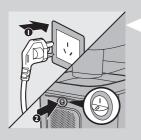
**5** 将电源插头插入接地的电源插座 (1) 并按下产品背面的开/关按 钮 (2) 以启动本产品。
