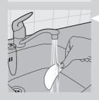
4 將鐵鏽與沉澱前層濾芯自固定座取下,並以熱水沖洗。
