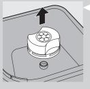
6 提起原水箱。要取下长效滤芯,请将其向左转动 (1),从原水箱中取出 (2)。
