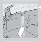
4 从滤芯架卸下铁锈和沉淀物预过滤网,然后在热水下冲洗。
