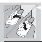
**3** 解除兒童鎖。若要解除兒童鎖,請將兒童鎖朝內推,同時壓下熱水桿。
