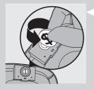
■ 使用硬幣拆下頂蓋內側的電池槽蓋。
