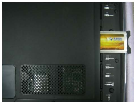
将CAM卡插入电视机PCMCIA插槽1
