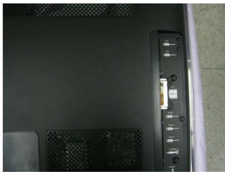
将CAM卡插入电视机PCMCIA插槽2
