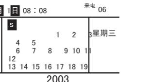
平时显示状态，“1月1日”表示月、日，“08:08”表示时间，“06”表示来电总数，“星期三”表示星期数，“2003”表示年。
